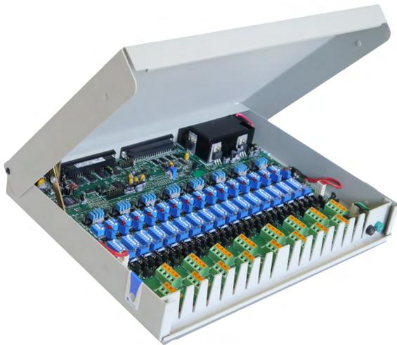
O ADS0500 é um sistema integrado de baixo custo. Indicado para aplicações onde não se trocam os sensores freqüentemente.
